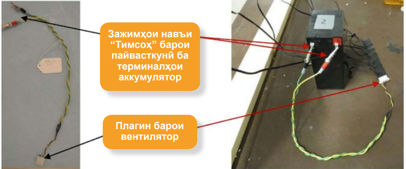
Расми 10. Пайвасткунии аккумулятор мустақиман ба вентиляторҳо. Тарафи чап. Симҳое, ки барои пайвасткунии аккумулятор ба вентиляторҳо истифода бурда мешаванд. Дар як охири он зажимҳои навъи “тимсоҳ” ҷой дода мешаванд ва дар охири дигар плагин ҷой дорад. Тарафи рост: Аккумулятори пайвастшуда ба плагин барои маҷмӯи 7 табақҳо, ки байни ҳамдигар дар қолиби вентилятор маҳкам карда шудаанд
