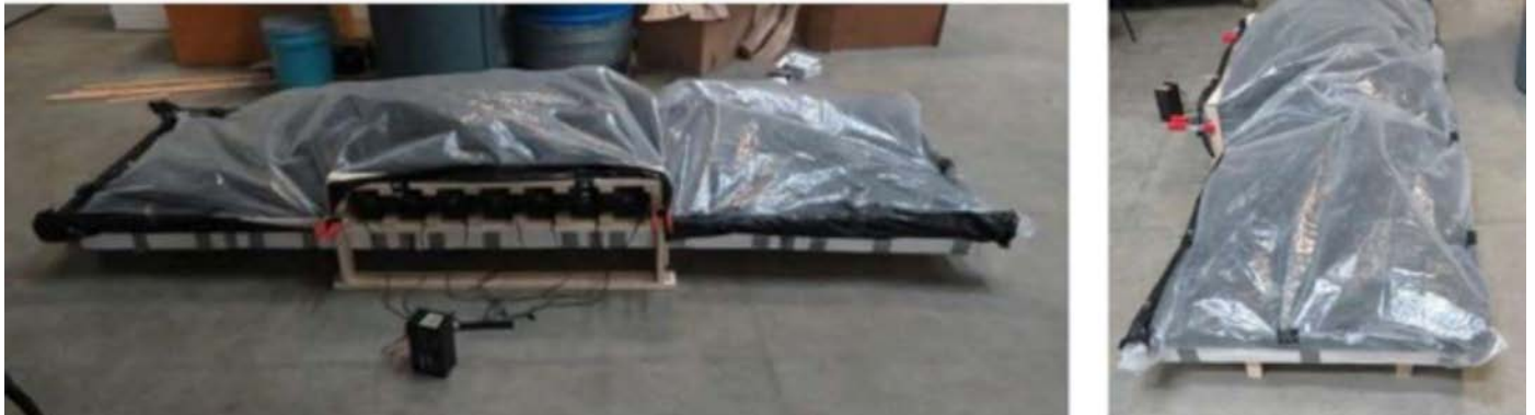
Расми 11. Расмҳои хушккунаки POD бо вентиляторҳои амалкунанда. Клеёнка бар асари фишори ҳаво, ки аз вентилятор мевазад, дам мешавад.
