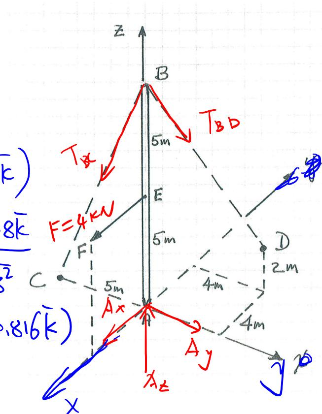
$$c) T_{BC} \approx T_{BD} \approx 4 \text{ kN}$$
