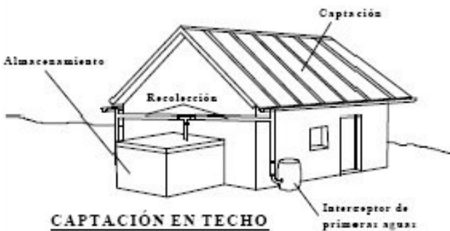
Ilustración 5 Esquema captación, tomado de http://www.organi-k.org.mx
